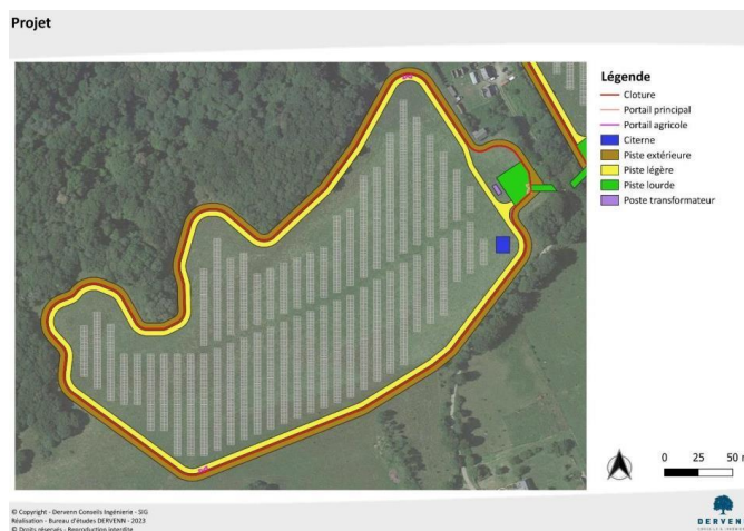
Figure 1. Exemple d'un des secteurs aménagés
